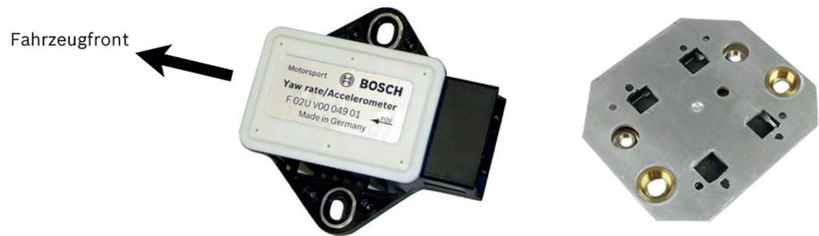
Der Drehraten-/Beschleunigungssensor ist auf das System abgestimmt. Montieren Sie ihn in der Fahrzeugmitte und horizontal auf der im ABS M4-Paket enthaltenen Dämpferplatte. Positionieren Sie den Sensor so, dass der Anschlussstecker in Richtung Fahrzeugheck zeigt.
