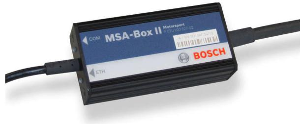
Über den Anschlussstecker „Diagnoseschnittstelle“ kann das ABS M4 per optional erhältlicher MSA Box II (siehe Kapitel Kommunikationsschnittstelle MSA Box II [▶ 17]) mit einem Laptop verbunden werden. Positionieren Sie den Anschlussstecker so, dass er leicht zugänglich ist. Mittels Programmier- und Diagnosesoftware (siehe Kapitel Programmier- und Diagnosesoftware [▶ 26]) können dann fahrzeugspezifische Parameter programmiert und Fehlermeldungen abgerufen und gelöscht werden.
