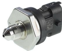
Der Bremsdrucksensor wird in den Vorderachsbremskreis zwischen Hauptzylinder und Hydraulikaggregat eingebaut. Der Sensor muss vor der Montage mit Bremsflüssigkeit befüllt werden, z.B. mit einer kleinen medizinischen Spritze. Montieren Sie den Bremsdrucksensor in einer Position, in der das Gewinde nach oben zeigt. Das erleichtert Ihnen die Entlüftung der Bremsanlage.
